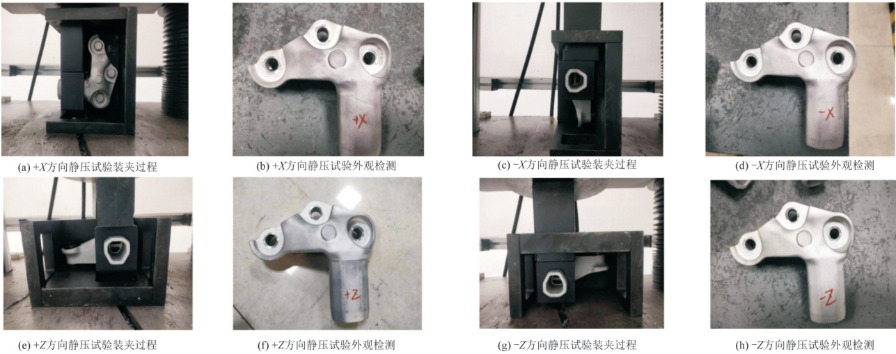
图 14 悬置托臂静压试验过程及结果
